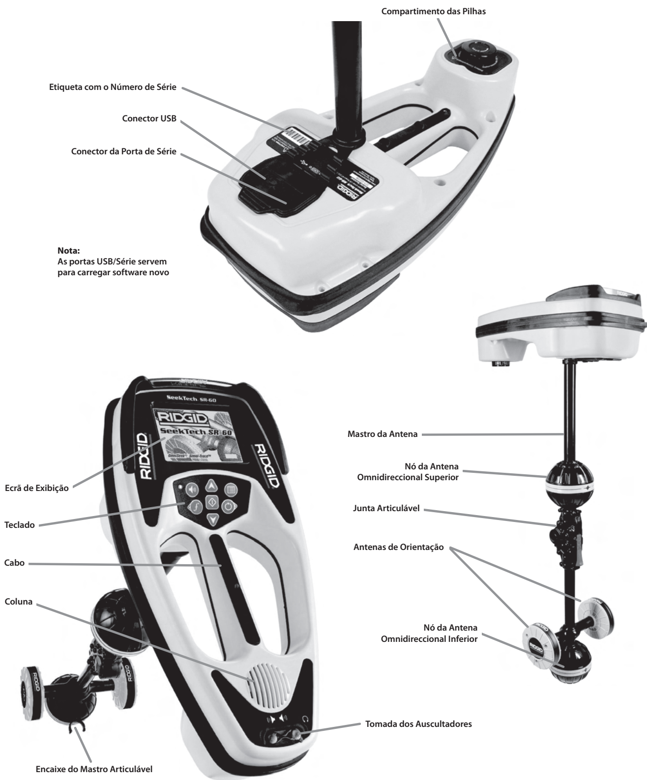
Figura 1: Componentes do SR-60
