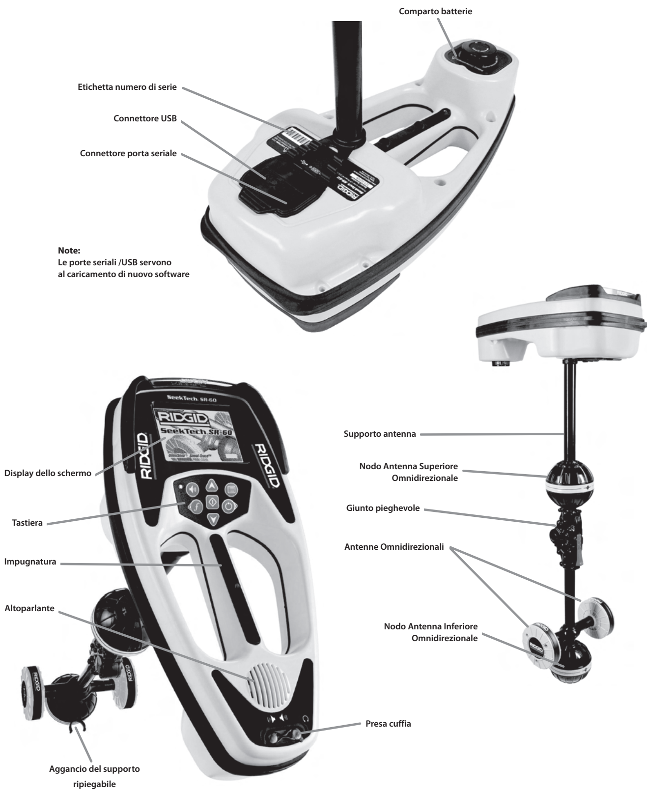
Figura 1: Componenti del localizzatore SR-60
