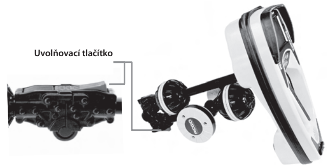
Obrázek 3: Sklápěcí stožár antény a uvolňovací tlačítko
