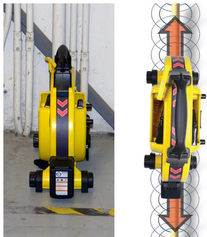
Figur 4 – Induktion med RIDGID SeekTech ST-33Q+
