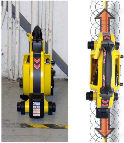
Figura 4 – Induzione tramite RIDGID SeekTech ST-33QR
