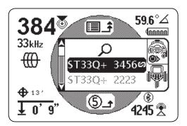
Una volta che la connessione è stata stabilita, il trasmettitore si accende automaticamente. Quando gli apparecchi sono connessi, l'icona Bluetooth (\*) è visibile sia sullo schermo del trasmettitore sia su quello del ricevitore. Sul trasmettitore, l'immagine di due anelli di catena collegati conferma che le due unità sono connesse.
