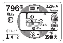
Se è presente più di un trasmettitore SeekTech abilitato al Bluetooth, premere il tasto Freccia a Sinistra per passare ciclicamente da un trasmettitore disponibile all'altro. Premere il numero di serie che appare sotto l'icona del trasmettitore per identificare lo specifico trasmettitore che si desidera regolare.
