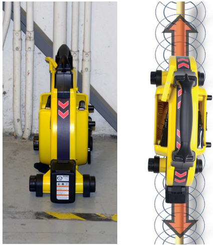
Abbildung 4 – Induktion mit RIDGID SeekTech ST-33QR
