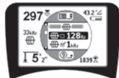
Rysunek 14: Wyróżnianie żadanej częstotliwości (128 Hz)
