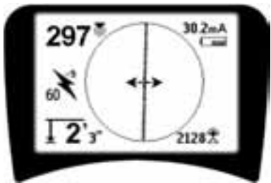
Rysunek 24: 60Hz (9-ta harmoniczna) - częstotliwość pasywnego śledzenia
