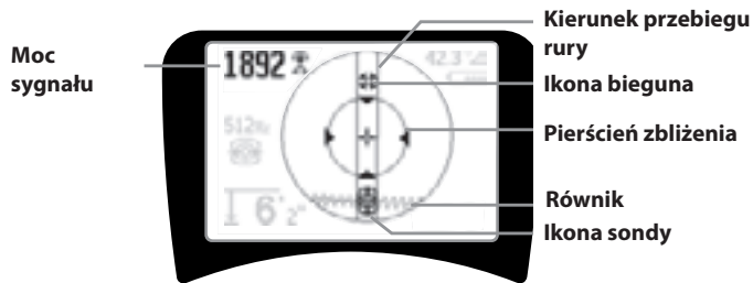
Rysunek 6: Elementy wyświetlania: Tryb Lokalizacja sondy
