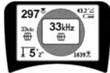
Rysunek 18: Częstotliwość śledzenia przebiegu linii wybrana za pomocą przycisku Częstotliwość
