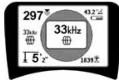
Figur 18: Linjeavsøkingsfrekvens valgt med frekvensknappen
