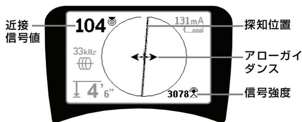
図5 - アクティブ探知モードのときの表示項目
