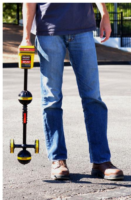
El sistema de antena omnidireccional del SR-24 mide señales electromagnéticas y calcula la fuerza, profundidad y grado de distorsión o interferencia de la señal. La visualización y las señales de audio multidimensionales le ofrecen una experiencia de localización que es inmediatamente intuitiva.
