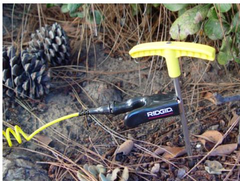
Con los clips conductores del transmisor colocados en la línea objetivo y la vara de conexión a tierra se crea un circuito en el que puede viajar la señal. El circuito permite que la corriente fluya, energizando a la línea objetivo.
