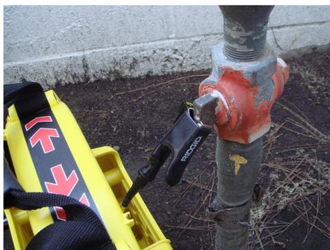
3. Empuje la vara de conexión a tierra hacia el suelo tanto como sea posible y coloque el otro clip conductor del transmisor.
