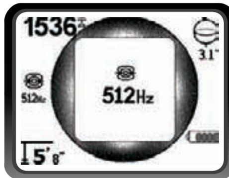
Рис. 23: Частота обнаружения трассы, установленная кнопкой выбора частоты
