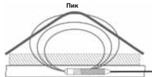
Рис. 36: Сигнал, который “видит” прибор NaviTrack® II
