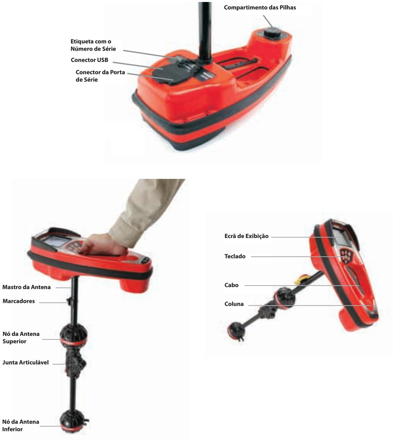
Figura 1: Componentes do NaviTrack® II
