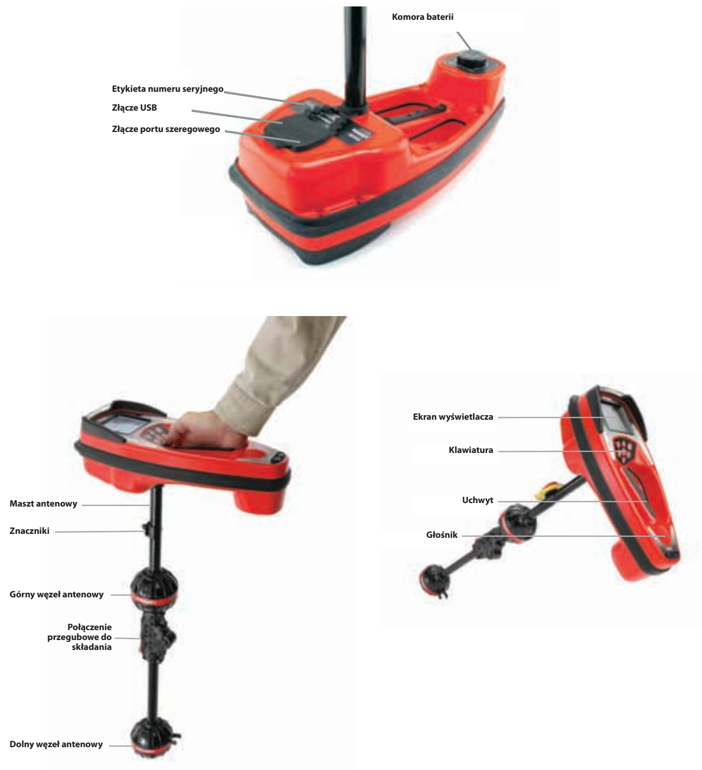
Rysunek 1: Części składowe lokalizatora NaviTrack® II
