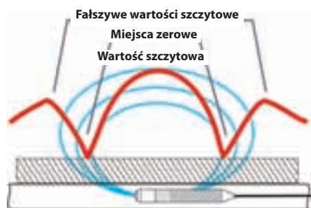
Rysunek 35: Sygnał sondy, "widziany" przez tradycyjny lokalizator
