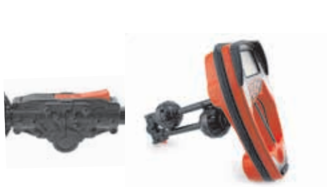
Figur 3: Sammenleggbar antennemast og utløserknapp
