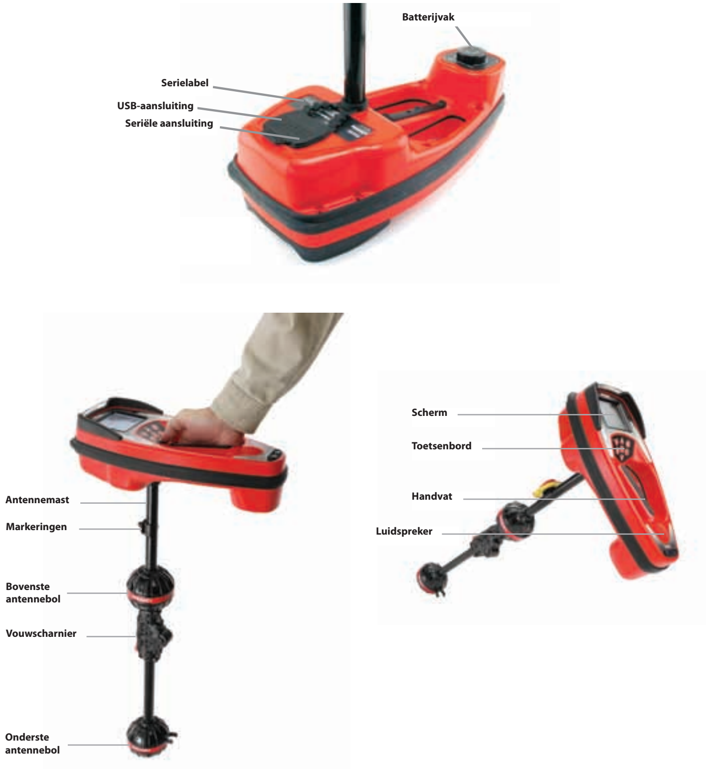
Figuur 1: NaviTrack® II-onderdelen
