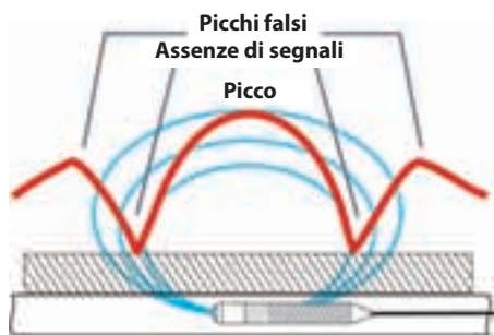
Figura 35: Il segnale da una sonda come viene "visto" da un localizzatore convenzionale
