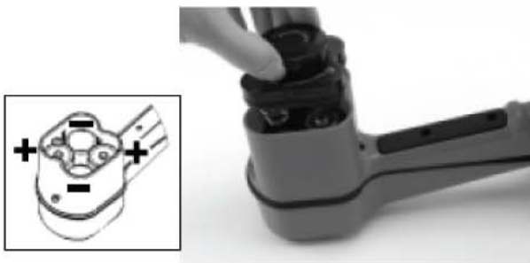
图8 - Scout的电池仓示意图
