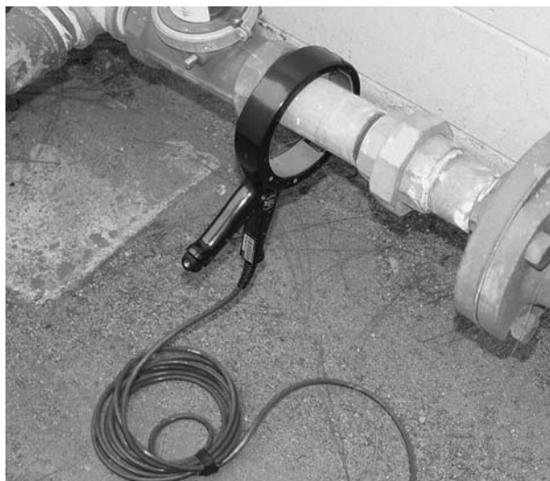
Figura 4 – Una manera de acoplar la pinza inductiva
