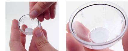
5. Соберите передатчик, защелкнув вместе половинки, и нанесите новую ленту вокруг экватора.
