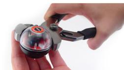
3. Sostituire entrambe le batterie CR2032.
