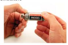
Per **ACCENDERE** il trasmettitore, avvitare completamente la copertura delle batterie. Quando il trasmettitore è ACCESO, il LED lampeggia.
