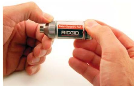
Pour **ALLUMER** le transmetteur, bien serrer le couvercle de pile. La LED va alors clignoter et le transmetteur est allumé.
