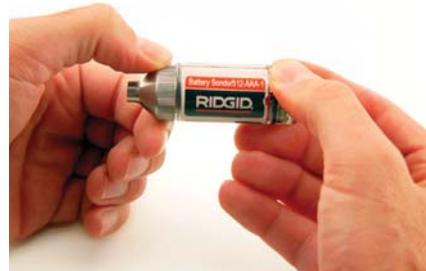
Um den Positionssender **AN** zu schalten, ziehen Sie die Batterieabdeckung fest an. Die LED fängt an zu blinken wenn der Positionssender AN ist.
